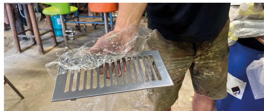
Hliníkové větrací mřížky zakrývající topná tělesa v přízemí i v prvním patře. Některé kováři repasovali a tam, kde chyběly, vyráběli nové.
