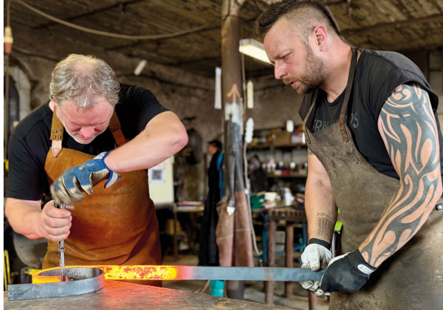
Kováři z Dalovic během výroby nového dílu balkonového zábradlí pro ostrovský Dům kultury.
