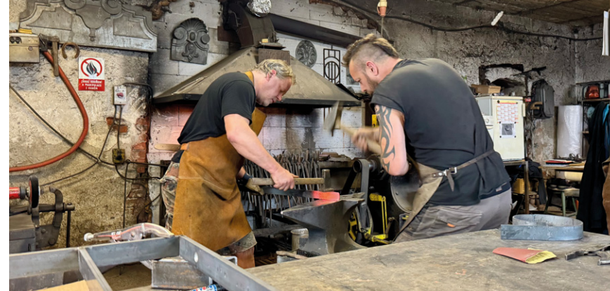
Tvarování části budoucího zábradlí na balkon Společenského sálu.
